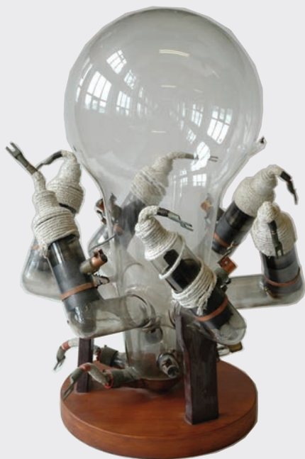
Redresseur à vapeur de mercure
